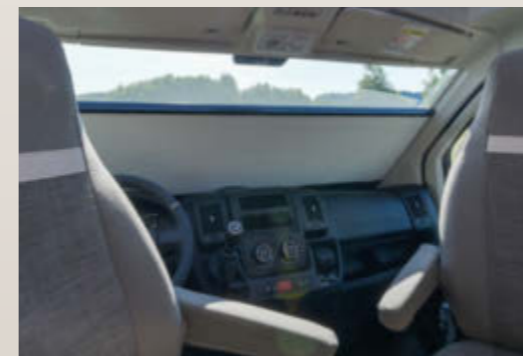
OSCURAMENTO PARABREZZA Dal basso verso alto: grande vista per fuori e più privacy al interno. Chiuso a metà si può guardare fuori, ma nessuno può guardare dentro . oscuramento parabrezza.
